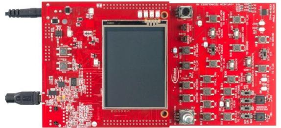
リアルタイムデータはTFT液晶ディスプレイとASCLIN Shellインターフェースに表示され、ボード上のタッチスクリーンとボタン/スイッチで故障を注入できます。AURIX™アプリケーションキットTC3xx Safetyは、評価ボードAURIX™ TC3xx Safety (EVABOARD\_A2G\_SAFETY) と呼ばれるアドオンのシールドボードに接続されたAURIX™ TC397アプリケーションキットTFT (KIT\_A2G\_TC397\_5V\_TFT)、電源、USBケーブル、小型磁石、クイックスタートガイド、プリフラッシュソフトウェアで構成されています。
