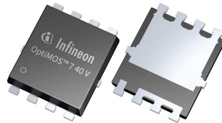
既存のOptiMOS™ 6 40 V製品に比べ、 $R_{DS(on)}$ は40%低減されています。さらに、SuperSO8パッケージを使用することで、DirectFET™ (L)ソリューションに比べてPCB面積を50%削減し、並列化の必要性をなくします。
